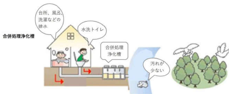
図 2-2 合併処理浄化槽のしくみ
