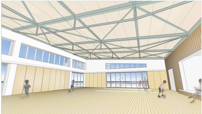
多目的ホール：一般的な鋼材を組み合わせた架構による軽快な空間。イベント時には駐車場とつながって使える。
