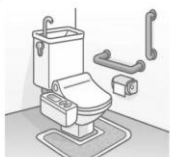
手すりの設置
